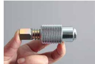
Schiebekupplung auf den Flachkopfnippel aufschieben | Glisser l'accouplement coulissant sur le nipple à tête plate
