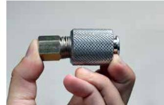
Sicherung gegen die Druckfeder zurückdrücken
